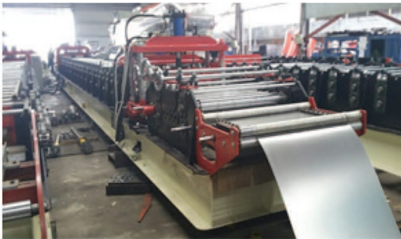
Dây chuyền chế tạo tấm cực lắng theo bản quyền profile của Nhật Bản
